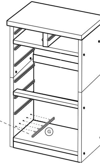
※レールはUの字になっている方を前側にして隙間なく押し込んで取り付けてください。
