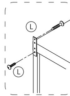
※L字プレートで本体を壁面に固定してください
