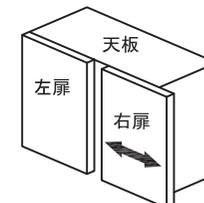
ネジAを右に回すと扉が内側に移動します。逆に左に回すと扉が外側に移動します。
