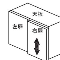
ネジCを左に回して緩め、扉の上下を正しい位置に合わせます。そしてネジCを右に回して固定します。
