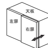
ネジBを左に回して緩め、扉の前後を正しい位置に合わせます。そしてネジBを右に回して固定します。
