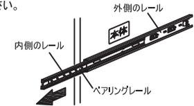
⚠️注意 スライドレールを取り付ける際は、必ず本体内側のレールから「ベアリングレール」を取り出した状態にしてください。
