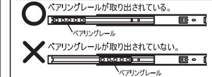
2 引き出したベアリングレールに、スライド部(引き出し、スライド棚など)のレールを3cmほど左右均等に差し込みます。
