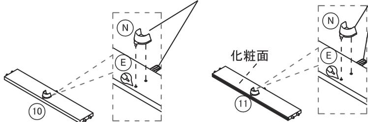
\*ハンガーパイプ受を取付ける時に接着剤を付けて下さい。
