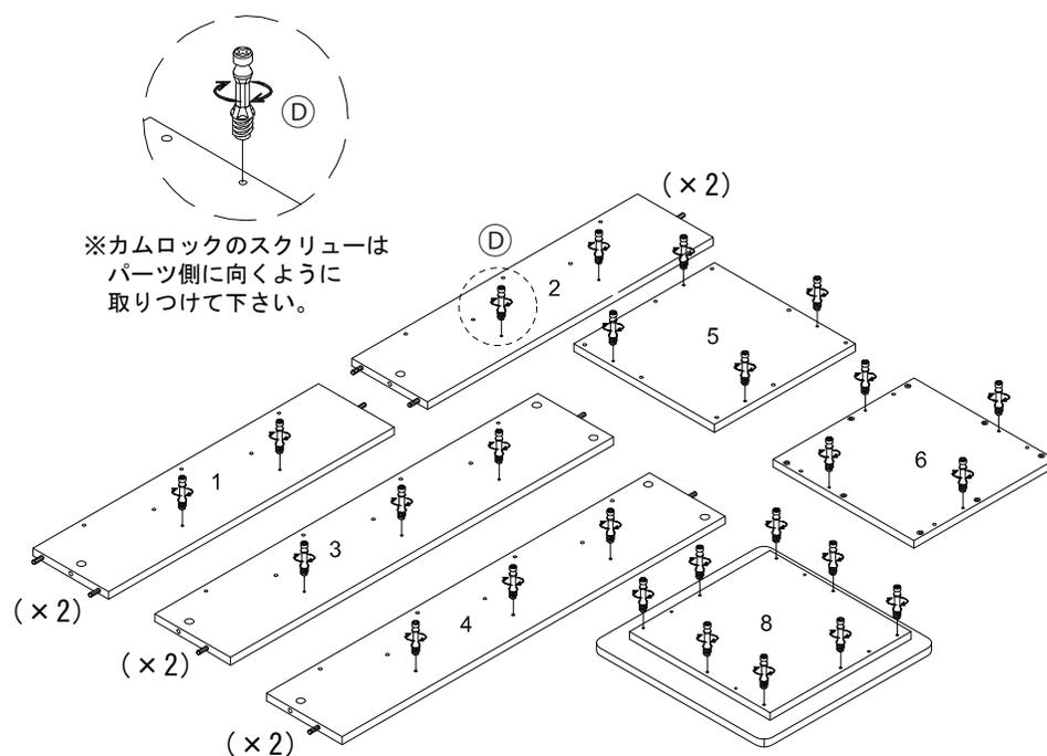
3 パーツ⑦に⑤Eカムロック受けをセットし、パーツ①の④Dカムロックボルトと組み合わせます。次に⑥F金属バーを図のように差し込みます。
