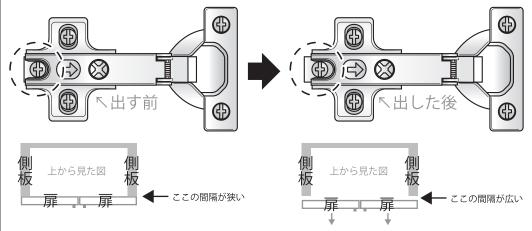
扉を本体に取り付けた後、扉を開閉してみて扉と本体側板の間隔をご確認ください。 側板と扉の間隔が狭いと、扉を開閉する際に側板に干渉し、側板が傷つく場合があります。 先ほど出した約3mmが丁度いい間隔の目安になりますが、もし開閉の際、扉の端が本体側板に当たったり、 するようでしたら、再度「間口調節ネジ」を緩めて微調節してください。
