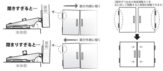
ヒンジは通常上下2つで1セットなので、「角度調節ネジ」を回すときは、上下のヒンジを合わせる必要があります。 片方だけ角度が違うと扉の傾きの原因になりますので、扉の傾きや隙間が気になる時は、ネジの回転数(1回転、2回転…を上下であわせて、ヒンジの角度を同じにしてあげる事で、扉をまっすぐ取り付けることができます。
