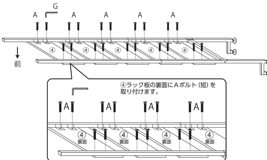
④ラック板の裏面にAボルト(短)を取り付けます。
