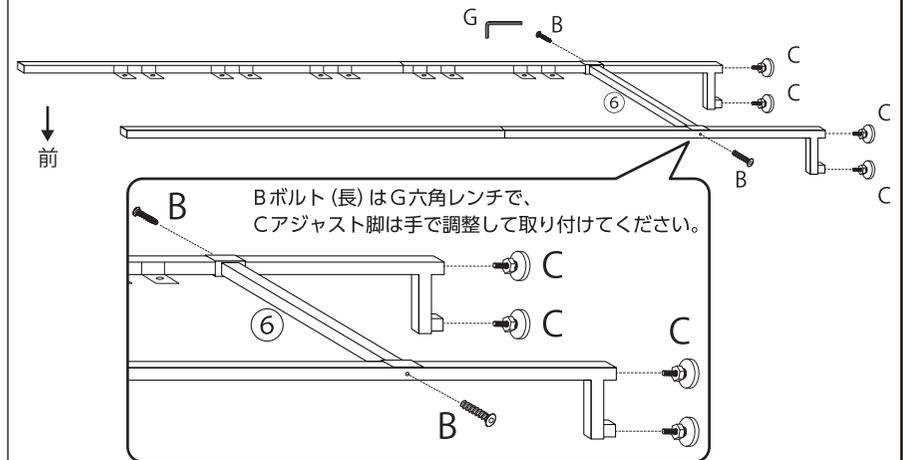
Bボルト(長)はG六角レンチで、Cアジャスト脚は手で調整して取り付けてください。
