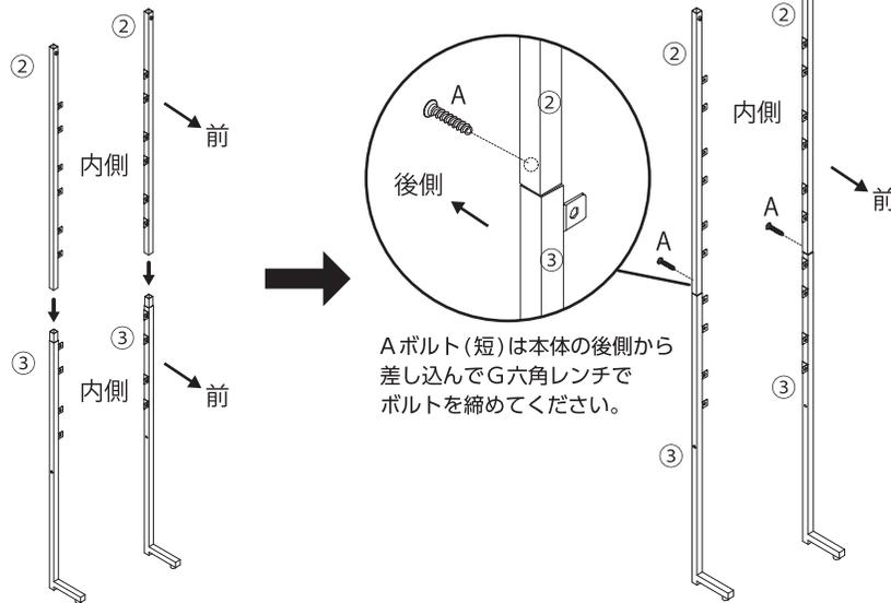
Aボルト(短)は本体の後側から差し込んでG六角レンチでボルトを締めてください。
