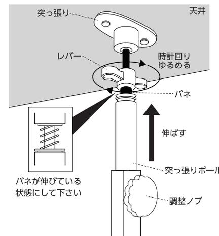
次にレバーを反時計回りに回して天井とポールを固定します。
