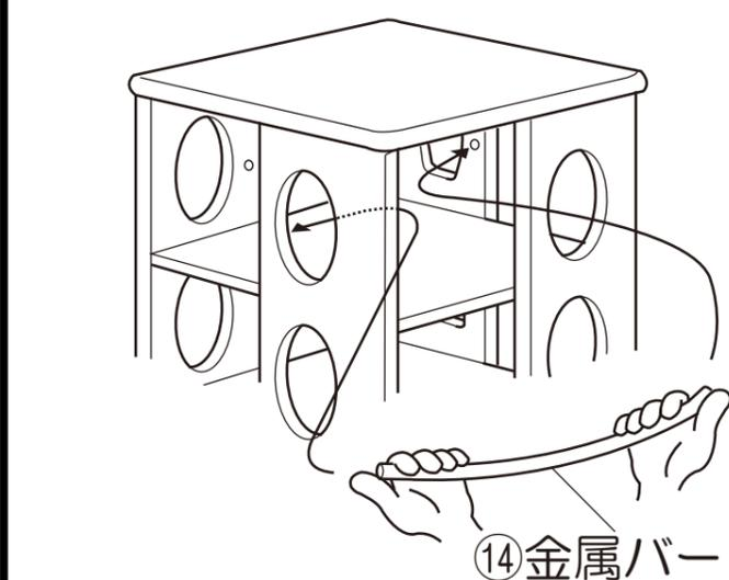
先に金属バーの片側を側板の穴に差し込み金属バーを軽く手で曲げながら取り付けます。同様に90度交差するように取り付けます。※この際、金属バーで本体を傷付けないようお気を付けてください。
