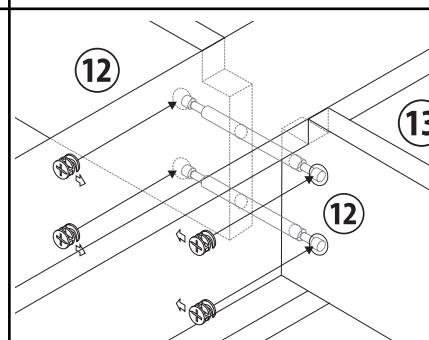
Bカムロック受けの向きに気を付けて(⑬の方へ矢印を向けて下さい)
