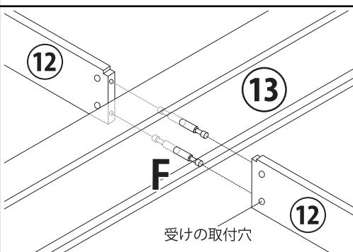
⑬を貫通させて、図のように⑫の側面にF双頭カムロックボルトを取り付けます。
