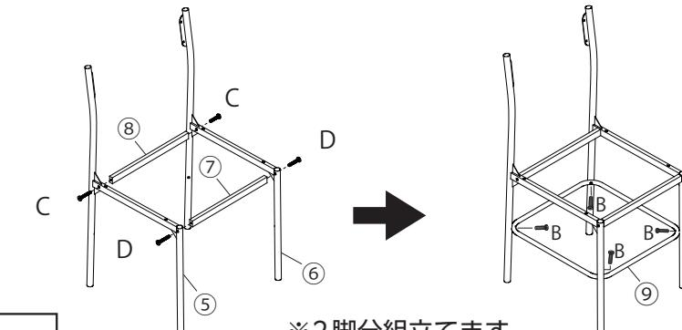
※ネジは必ず「仮締め」で取り付けて下さい。
