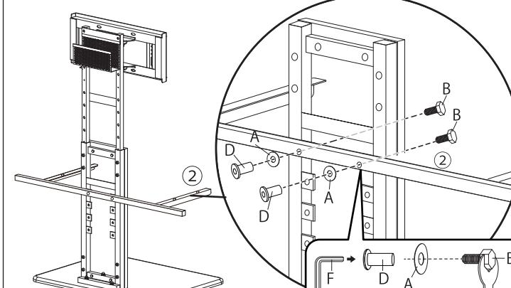
②ブラケットの取付場所を変更する事で、専用棚の高さを4段階で調整できます。
