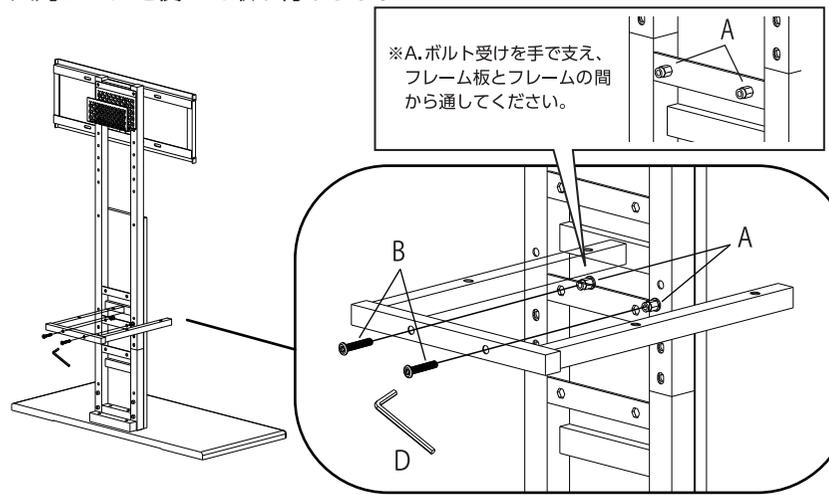
②専用棚ブラケットの取付場所を変更する事で、専用棚の高さを3段階で調整できます。
