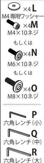
テレビの裏面に⑦テレビ用ブラケットBを、M.M4×10ネジとLM4ネジ専用ワッシャーもしくはN.M6×10ネジか、O.M8×10ネジと六角レンチを使用して取り付けます。
