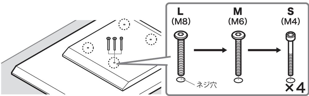
**ステップ 2** ネジ穴の深さを測定し、それぞれ使用するネジの長さを決めます。
