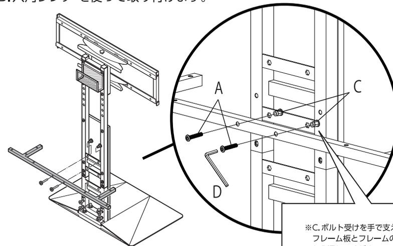
②ブラケットの取付場所を変更する事で、専用棚の高さを3段階で調整できます。
