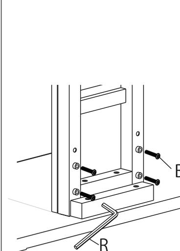
⑤テレビ用ブラケットBと⑧HDドライブ収納をD.ネジ、G.ワッシャー、H.ボルト、R.六角レンチ(小)、U.スパナ(小)を使って固定します。
