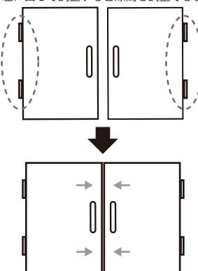
ヒンジは通常上下2つで1セットなので、「角度調節ネジ」を回すときは、上下のヒンジを合わせる必要があります。片方だけ角度が違うと扉の傾きの原因になりますので、扉の傾きや隙間が気になる時は、ネジの回転数(1回転、2回転...)を上下であわせて、ヒンジの角度を同じにしてあげる事で、扉をまっすぐ取り付けることができます。
