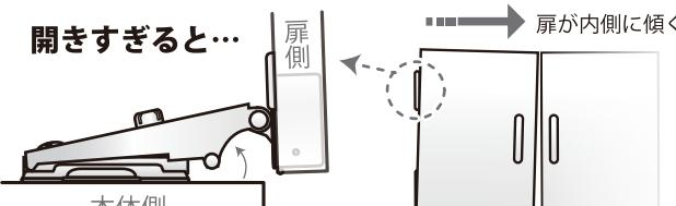
扉に隙間がある場合、2箇所ずつ左右の角度調整ネジを左に回して調整すると隙間を調整できます。
