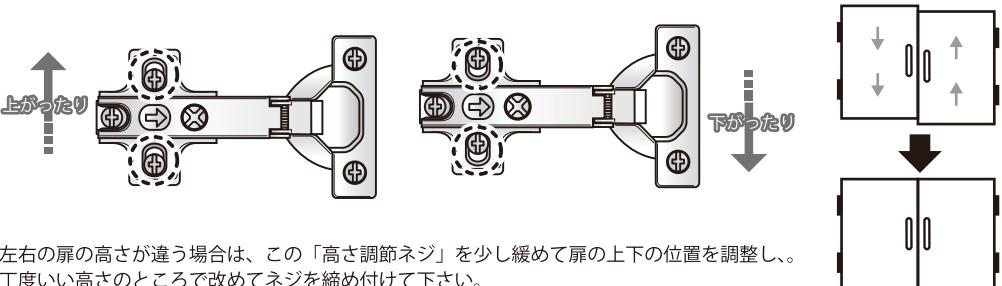
左右の扉の高さが違う場合は、この「高さ調節ネジ」を少し緩めて扉の上下の位置を調整し、丁度いい高さのところで改めてネジを締め付けて下さい。
