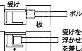
受けを少し穴の底から浮かせた状態でボルトを差し込みます。
