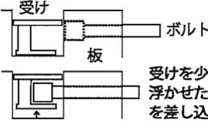
受けを少し穴の底から浮かせた状態でボルトを差し込みます。
