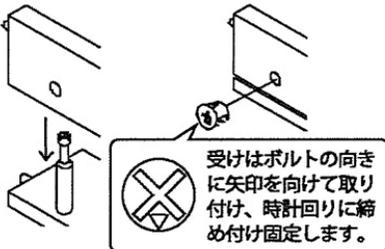
受けはボルトの向きに矢印を向けて取り付け、時計回りに締め付け固定します。
